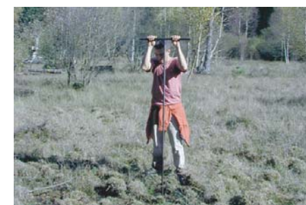
Figure 2 : Prélèvement d'une carotte de tourbe au Port-des-Lamberts par un étudiant de Master Pro 2 – Archéosciences de l'Université de Bourgogne.
